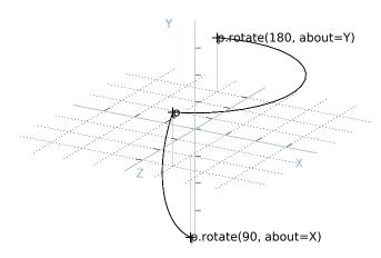
>>> X.rotate(180, about=X + Y).round() Vector(x=-0.0, y=1.0, z=-0.0)
